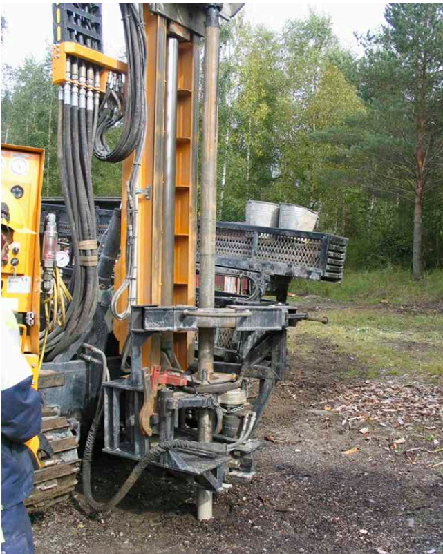
← Kuva 10. Yleisimmin käytetty näytteenotin oli tässä vertailussa putkiotin.
