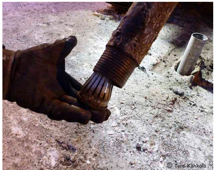
← Kuva 10. Yleisimmin käytetty näytteenotin oli tässä vertailussa putkiotin.
