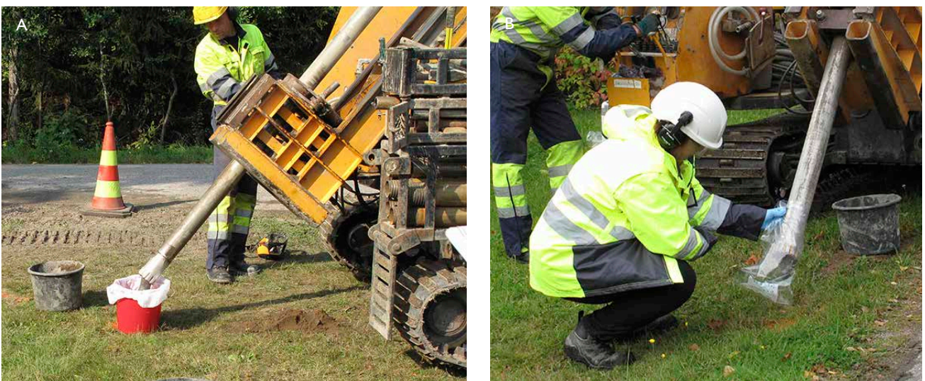
Kuva 7. Näytteet otettiin useimmin ämpäriin, josta kerättiin osanäyte astiaan. Astiassa olevasta näytteestä tehtiin kenttämittaus ja otettiin edustava osanäyte laboratorioon (A). Muutamat osallistajat ottivat laboratorioon näytteet suoraan näytteenottimesta kaasutiiviisiin pusseihin, joka oli suoraan laboratorioonäyte tai pussista otettiin vielä edustava osanäyte laboratorioon (B).
