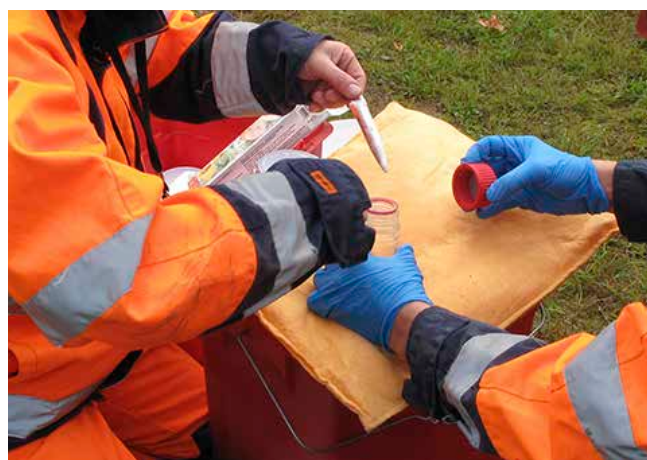
Kuva 16. Kaksi osallistujaa kestäväi haihtuvien orgaanisten yhdisteiden näytteensä jo kentällä. Kun näyte kestäväidään kentällä, otetaan toinen osanäyte kuivapainomäärityksiä varten (A). Pullon täyttö onnistuu hyvin sopivilla välineillä ja työturvallisuudesta huolehditaan imeytystyynyllä (B).
