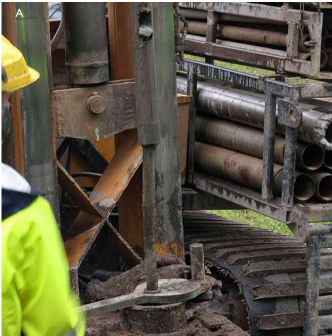
Kuva 13. Läpivirtausotin toimii niin, että näyte työnnetään alakautta metallitangon avulla ulos läpivirtausotimen aukkokohdasta (A). Maaperän laadusta riippuen näytteenottimen tyhjentämisessä joudutaan käyttämään erilaisia työkaluja läpivirtausotimen tyhjentämiseen (B).
