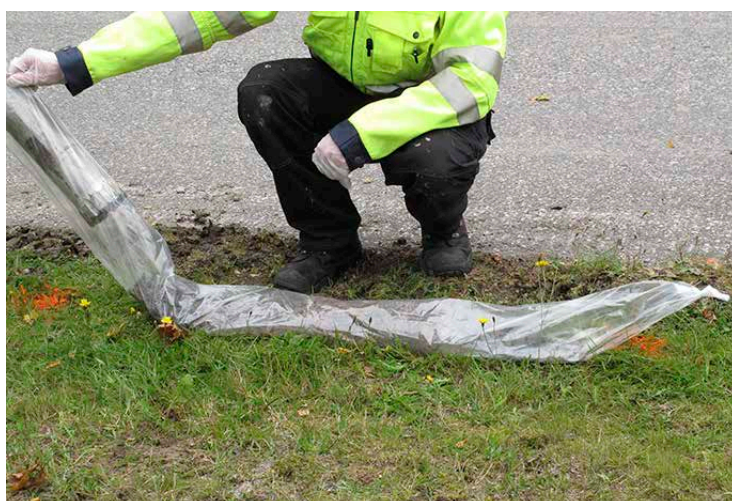
Kuva 9. Osallistuja R8 keräsi putkiottimesta näytteen muovisukkaan, jolloin maanäytteen maalajit voitiin hyvin kartoittaa.
